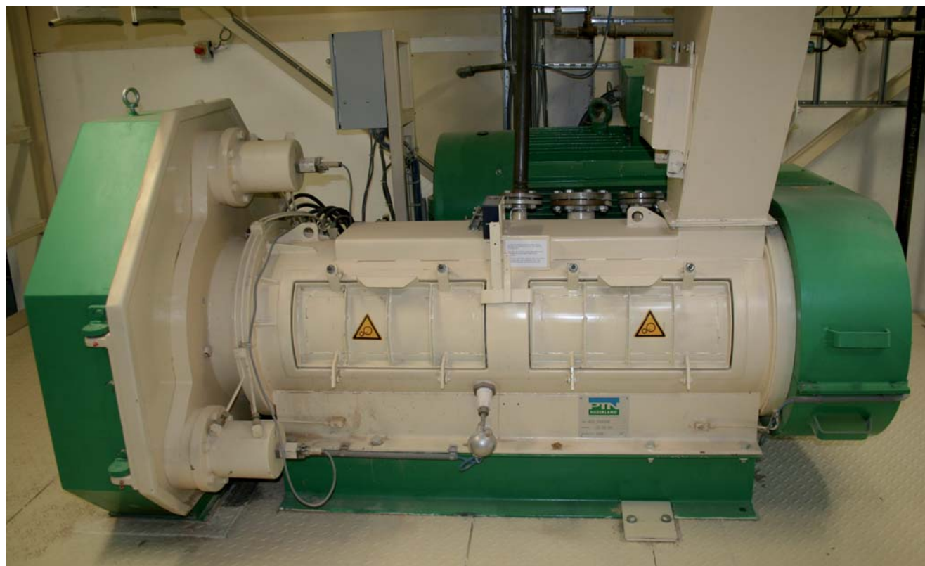
De gemoderniseerde proefvoerlijn met BOA heeft een maximale capaciteit van 8 ton per uur.
